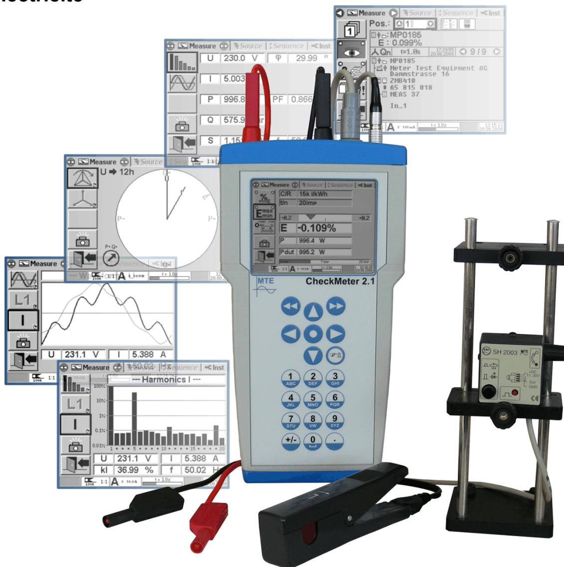
L'unité CheckMeter 2.1 est un compteur étalon électronique portable, monophasé, de la classe de précision de classe 0.2. Il est utilisé pour vérifier des compteurs sur site.
